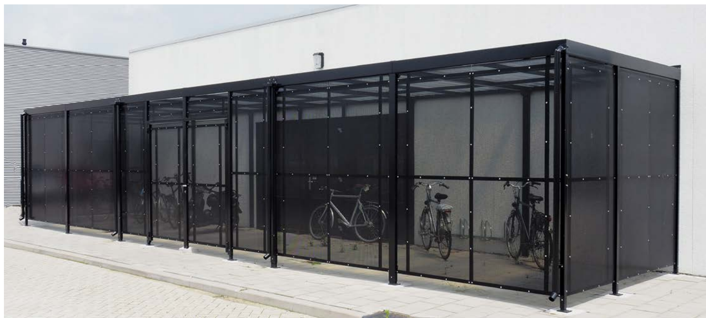
Wanden bekleed met perforeerplating in RAL 9005, staalconstructie gepoedercoat in RAL 9005. Verhoogde overkapping met dubbele deur.
